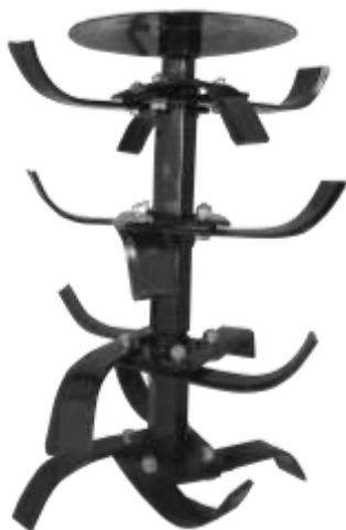
3. Ábra – Rotációs kések összeszerelése
