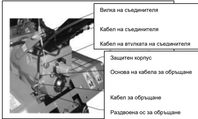
Фиг. 6 – Инсталиране и регулиране на съединителния лост
