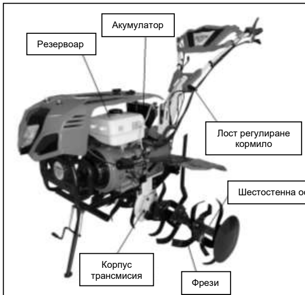
Фиг. 4 – Монтаж на елементите на мотофрезата
