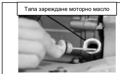
Фиг. 5а – Проверка на нивото на моторното масло
